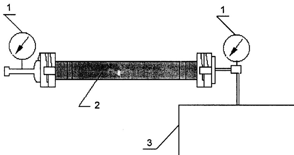
1 - мановакуумметр; 2 - всасывающий или напорно-всасывающий пожарный рукав;
